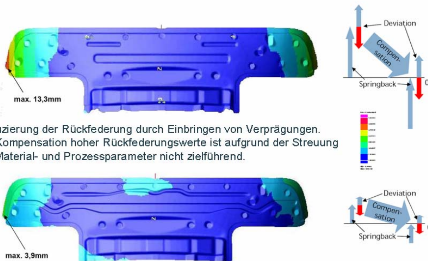
Bild 6: Versteifung eines flächigen Bauteils durch Sicken
