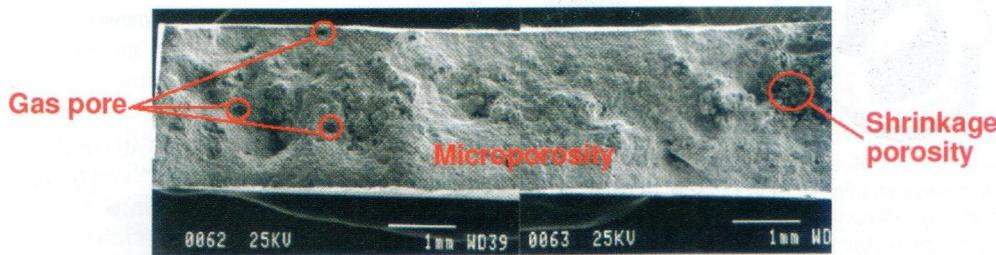
Bild 7. Eine starke Vergrößerung einer Bruchstelle zeigt die drei Arten der Porosität (a) Gasporen mit einer regelmäßigen runden Form und glatter Oberfläche, (b) Mikroporosität durch Schwindung mit einer unregelmässigen Form, die an die Struktur der Dendriten angelehnt ist, (c) Makroporosität mit unregelmässiger rauer Oberfläche (Bild mit freundlicher Genehmigung der Alcan Technology & Management SA, Neuhausen, Schweiz)
