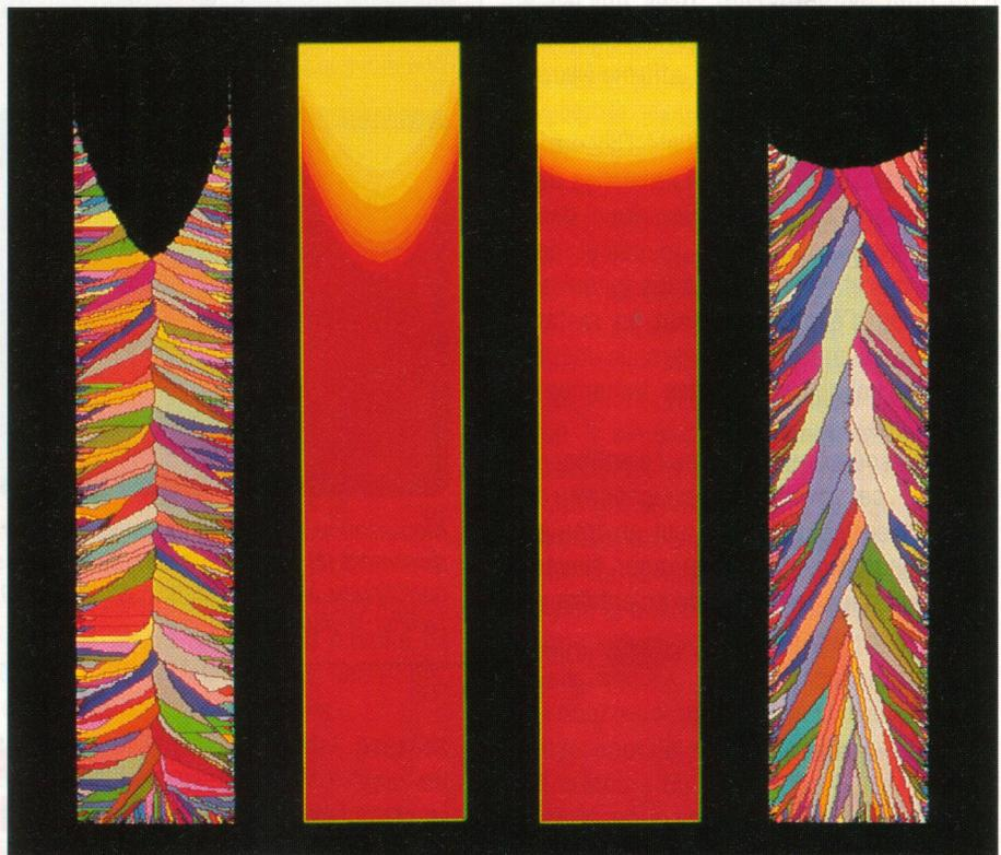
Fig. 4. – Modélisation du champ thermique lors de la coulée continue et représentation de la microstructure en grains qui en résulte. On voit que pour les conditions données, une vitesse de coulée trop rapide (fig. 4a) provoque une ligne ségréguée centrale très marquée car l'orientation des grains est dictée en premier lieu par l'orientation du flux de chaleur.
