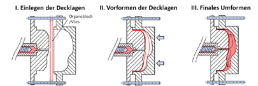
Abbildung 1: Schematischer Ablauf der Sandwichherstellung
