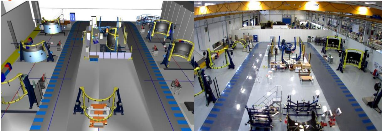
**Image** : La ligne d'assemblage du Transcowl A330neo en réalité virtuelle (à gauche) et dans la réalité (à droite).
