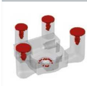
Рис. 1: Дефекты первых отливок до внесения изменений
