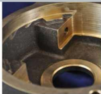
Рис. 2: Вид дополнительного литника для подачи металла в нижнюю часть детали треугольного сечения во время охлаждения
