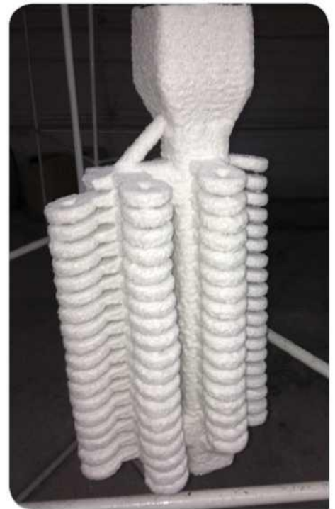
Физическое литниковое дерево с моделями деталей клапана
