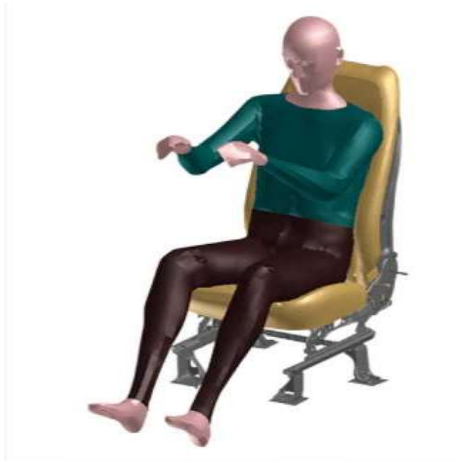
Рисунок 2. Виртуальное прототипирование сиденья специалистами Lear: положение модели человека в сиденье
