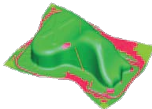
Prototype virtuel avec PAM-STAMP 2G et 1 er prototype réel
