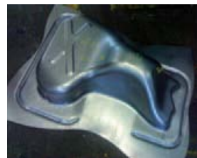
Prototype virtuel avec PAM-STAMP 2G et 1 er prototype réel
