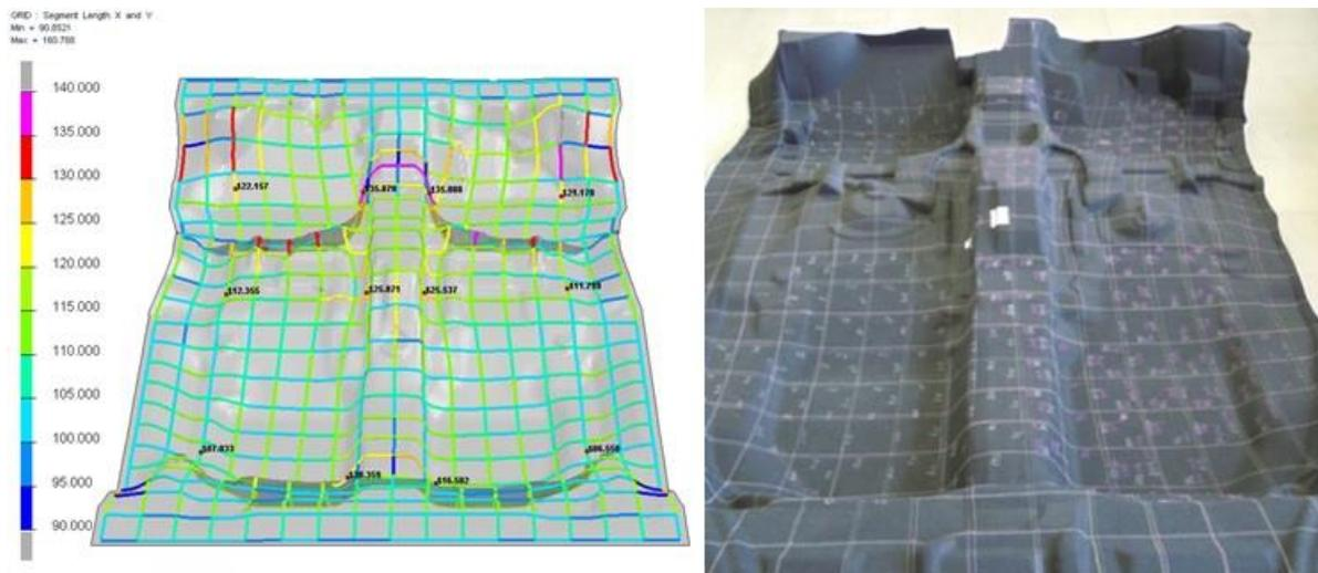
**Image :** Comparaison entre la grille simulée avec ESI PAM-COMPOSITES (à gauche) et la grille physique (à droite) d'un tapis de sol automobile synthétique
