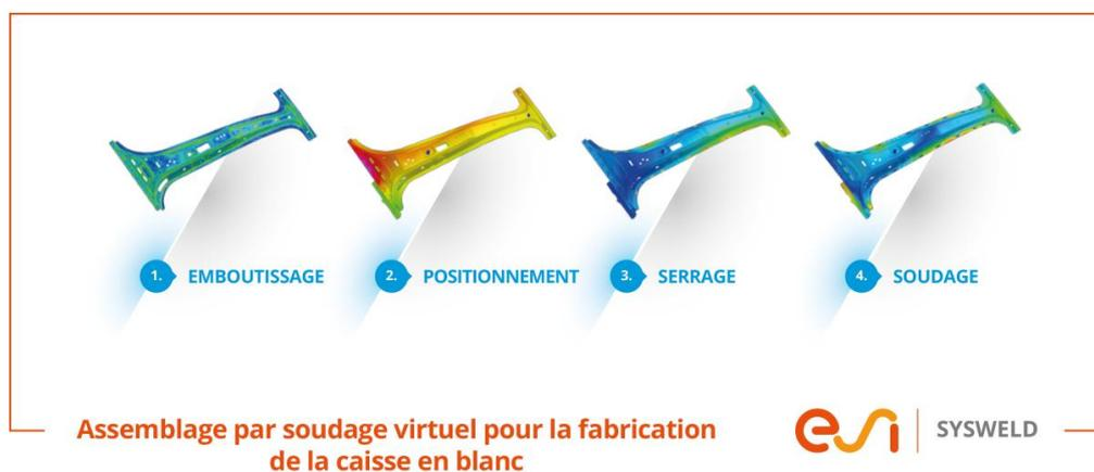
**Image** : En incorporant les propriétés des composants « tels que fabriqués » à l'atelier de presse, ESI SYSWELD peut simuler l'ensemble de la chaîne d'assemblage et de soudage d'une caisse en blanc, étape par étape.
