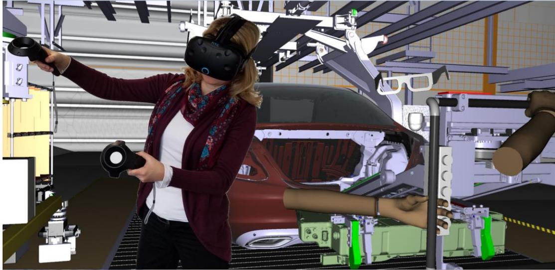
*Grâce à NVIDIA VRWorks, les utilisateurs d'ESI IC.IDO peuvent efficacement mener des évaluations immersives avec un HMD depuis leur bureau, avant de conduire des revues dans des CAVEs ou face à des Powerwall*
