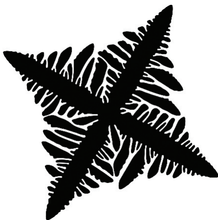
Rys. 1. Kształt dendrytu dwuwymiarowego uzyskany w modelu w skali mezo [1].
